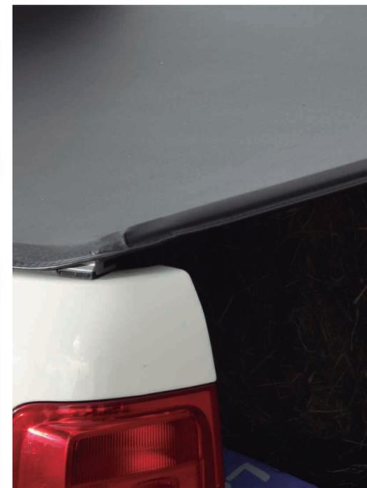
Estrutura de Alumínio | Sistema de trava em alumínio injetado tipo Trek | Travamento lateral em baguete | Produto pré montado direto de fábrica
