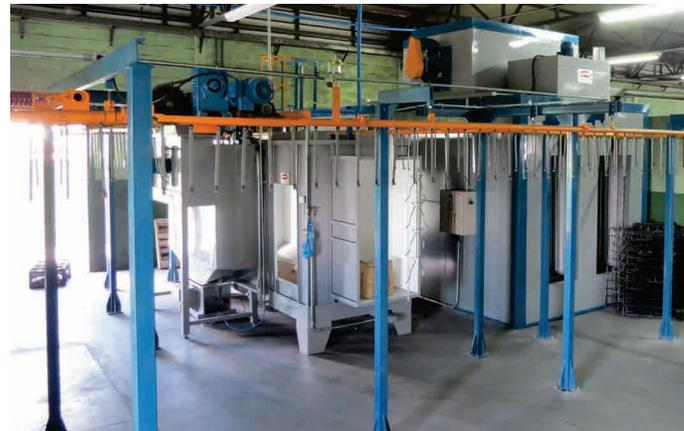
Na Metalúrgica, são fabricados os componentes em aço, com uma moderna linha de corte, dobra e pintura eletrostática, além de injetados e extrudados. A Flash Cover fez altos investimentos em maquinários modernos de tecnologia para a produção, entre esses maquinários, uma linha totalmente automatizada para o corte preciso das lonas; além do sistema para a pintura das peças epóxi, estação de tratamento, pintura automatizada, fundição de alumínio (injeção de alumínio sobre pressão) e estamparia.
