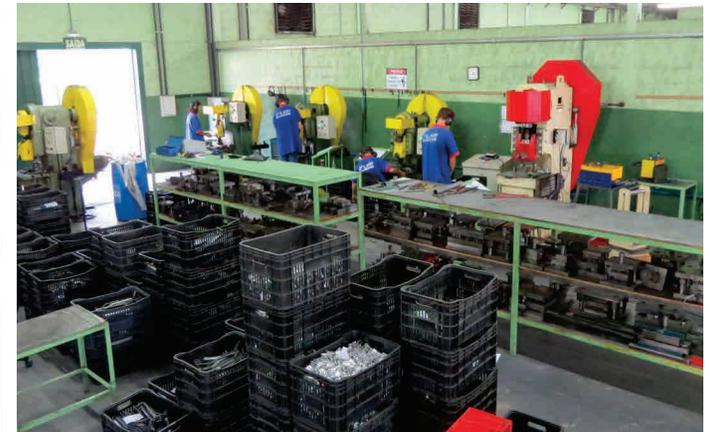
Para assegurar a satisfação de nossos clientes, a opção adotada foi a produção própria dos componentes que integram as capotas, na qual a fábrica produz 90% das peças, sendo utilizado maquinário de ponta e tecnologia nos processos de injeção termoplástica, como o nylon, poliacetal e pvc, além do processo de extrusão PEBD e P.V.C. A produção própria permite ter livre acesso ao desenvolvimento do produto, além de garantir a qualidade e minimizar o custo do produto aliado ao custo da matéria prima.
